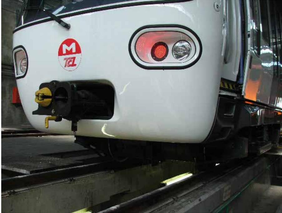
Pour l'inspection des rames, les voies sont posées sur fosses.
