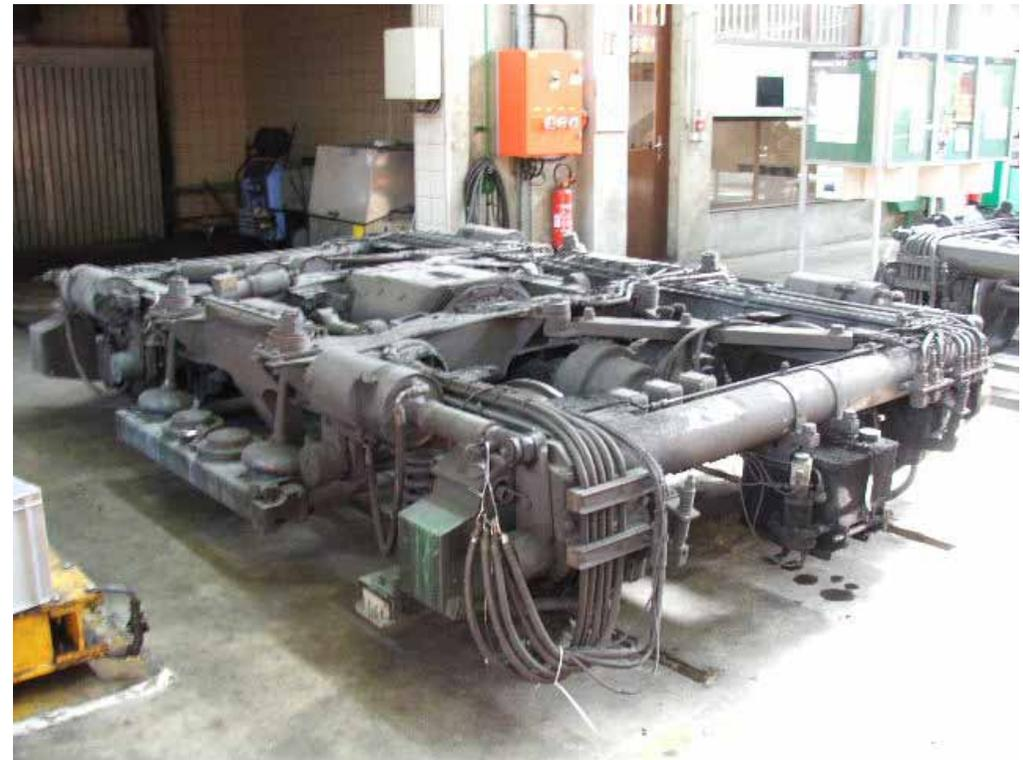
Pour le transport, les 2 éléments de la rame ont été scindés. Un treuil permet de soulever les caisses pour en retirer les boggies.
