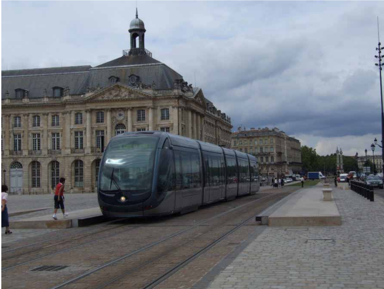
Citadis 30m Ligne C station Place de La Bourse. On notera que pour ne pas dénaturer les bâtiments, la station n'est pas aménagée et la section est en APS !
