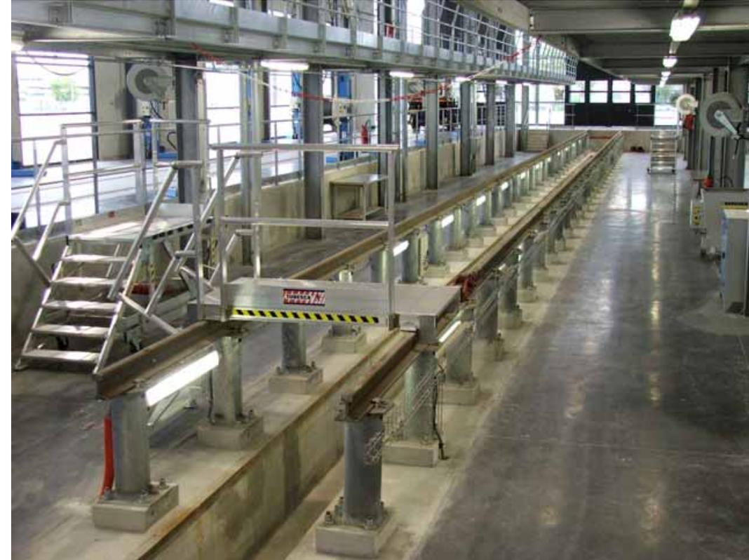
Le centre de maintenance de Meyzieu dispose de voies sur fosse ainsi que de nacelles pour accéder aux éléments de toiture des rames. Cependant, pour les maintenances plus lourdes (collisions lourdes, remise en état d'organes, grosses révisions) et pour le reprofilage des roues, les rames doivent se rendre à St Priest, via T3, T1 puis T2. Un trajet un peu long mais qui n'est effectué qu'occasionnellement.
