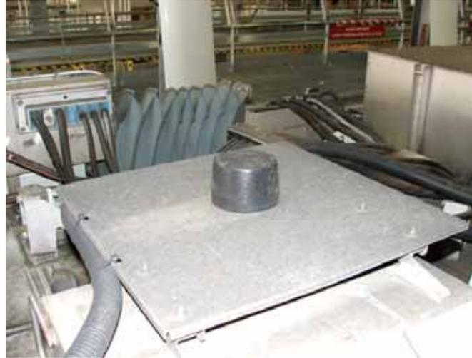
L'antenne du radio-téléphone, pour les communications PCT / Conducteur et les annonces voyageurs.
