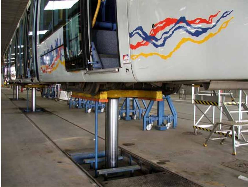
Autre salle, autre fonction. Ici, on lève les rames grâce à de puissants vérins hydrauliques, afin de travailler sur les boggies. Les boggies sont les éléments qui portent la caisse du tramway, et sur lesquels sont positionné les roues et les moteurs de la rame. Ainsi, une fois levée, les boggies restent sur la voie et peuvent être déplacés pour maintenance.
