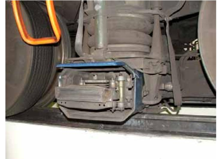
Ci-dessous, un organe essentiel : ce sont ces antennes qui lient le train au PCC, et c'est grâce à cet élément que le train se dirige automatiquement. Elles communiquent avec le tapis de pilotage automatique présent entre les voies. En cas de perte de communication « sol / train », le train est automatiquement freiné en urgence, et les équipes de maintenance doivent procéder à une intervention sur place.
