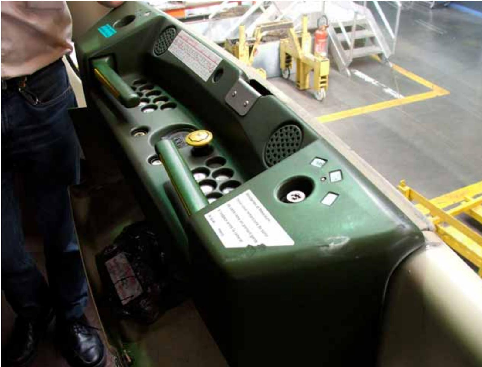
A chaque extrémité des rames, un poste de conduite simplifié est présent pour permettre aux agents des ateliers de piloter les rames dans le dépôt.
