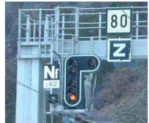
\*Les indicateurs de directions: Afin d'être renseigné sur l'itinéraire tracé par l'aiguilleur, des indicateurs de direction sont montés avec le signal de protection de l'aiguille et présente un feu blanc pour la première direction géographique à partir de la gauche, 2 feux pour la deuxième direction géographique à partir de la gauche, 3 feux pour la 3ème direction, etc...
