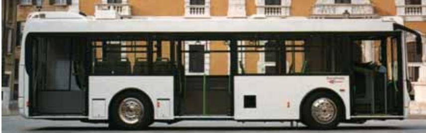
L'Irisbus Europolis sera accessible grâce à un plancher bas intégral. Contrairement à ce modèle thermique, il possédera 2 portes, et un capot sur la toiture plus important pour l'emplacement des batteries.
