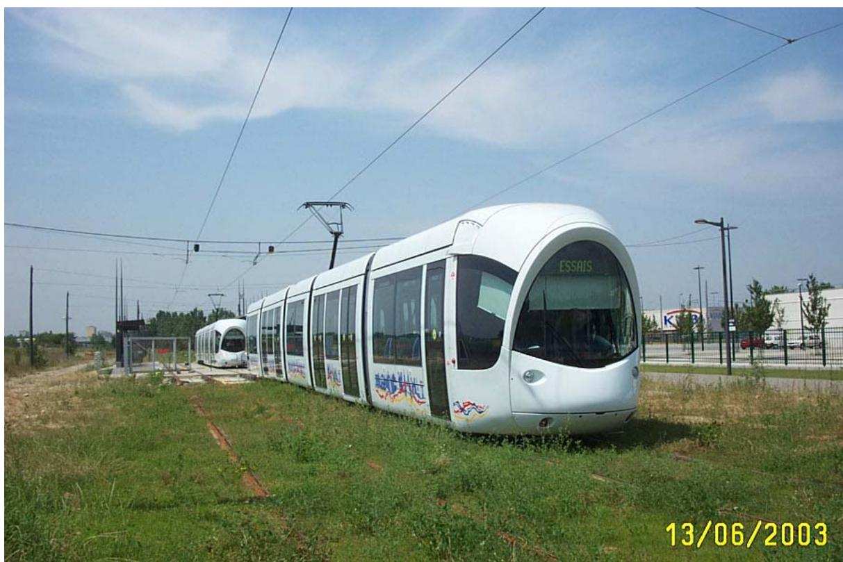
Une rame en service commercial (au fond) et la rame d'essai sur la nouvelle portion (1<sup>er</sup> plan)
