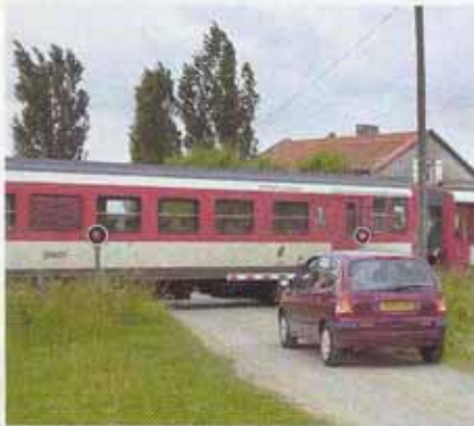
③ ...le train arrive. Durant toute la durée de son passage, les demi-barrières restent abaissées. Le feu continue à clignoter...
